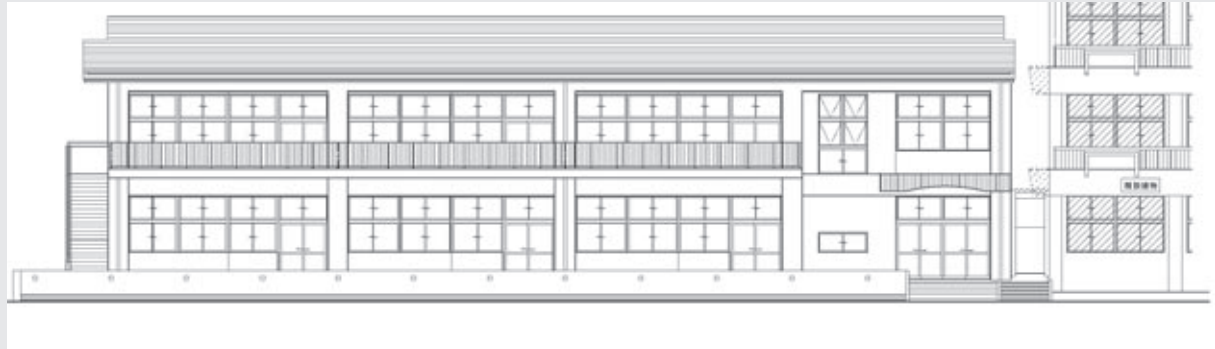
▲新校舎の南側立面図。1・2階に3学級ずつ増築します。右端は現在の校舎です。
