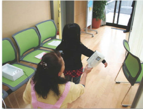
(右) 測定前には衣服などに放射性物質が付着していないか専用のサーベイメータで測定します (左) 測定後、すぐに検査結果をお知らせします
