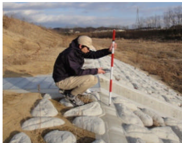
▲五百川護岸ブロック工事の線量を測定する様子(写真:福島県提供)
