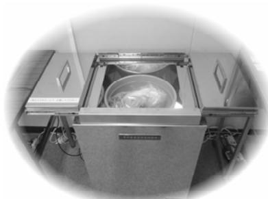
▲非破壊式放射能測定装置
